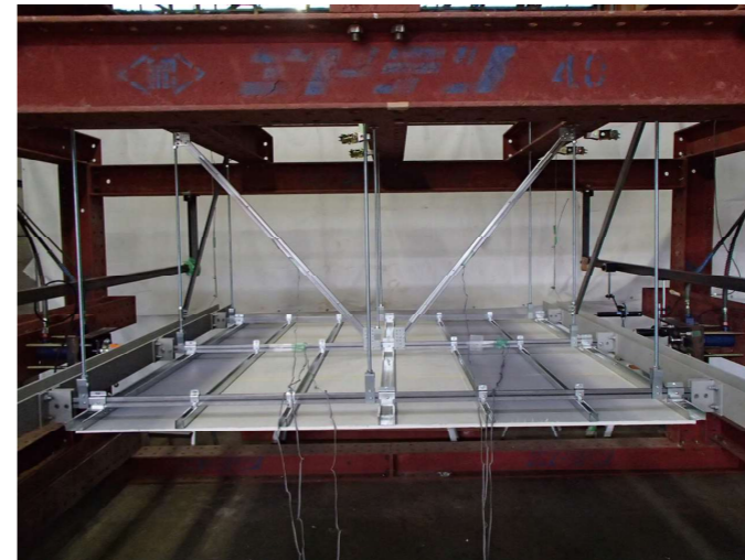
野縁受け方向ユニット試験
