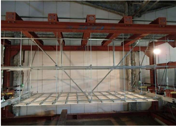
野縁受け方向ユニット試験
