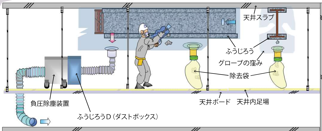
「ふうじろうによる天井内耐火被覆除去方法」イメージ図
