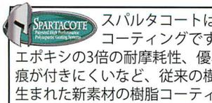
スパルタコートは、ポリアスパラティック樹脂の新世代樹脂コーティングです。硬化が早く塗布後2時間程度で歩行可能。エポキシの3倍の耐摩耗性、優れた耐薬品性、170℃までの耐熱性、タイヤ痕が付きにくいなど、従来の樹脂に比べ多くの優位性を持つ、アメリカで生まれた新素材の樹脂コーティングです。
