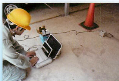
コンクリート振動測定 30dB～90dBを測定
