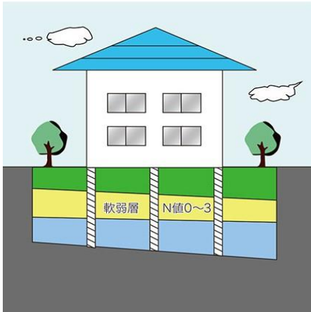
ソイルセメント柱状改良工法
